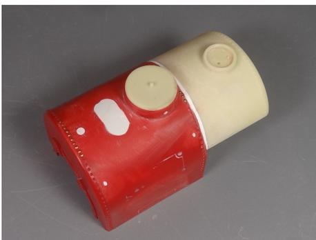
stück bündig an und verspachteln den entstandenen Spalt am besten mit Karosseriefeinspachtel. Mithilfe der Bohrschablone und den beiliegenden Nieten können Sie am originalen Satteltank die fehlenden Niete ergänzen. Kleben Sie zum Schluss den Tankdeckel auf den gekürzten Dampfdom.
